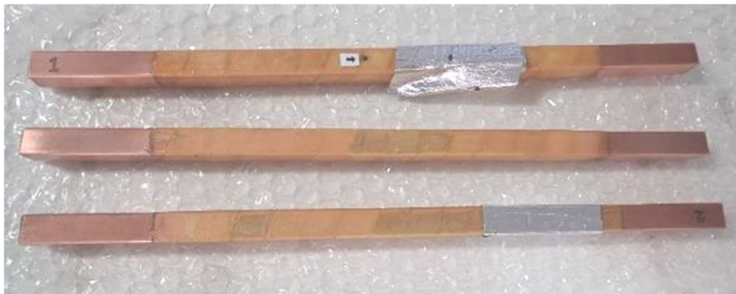
図1．シアネート製プリプレグテープを導体に巻き付け硬化させたサンプルの写真
