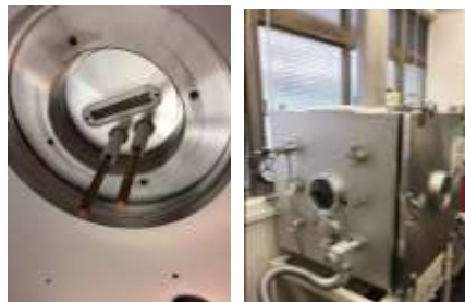
図2 長尺真空チャンバーと電気信号・通電コネクタ
