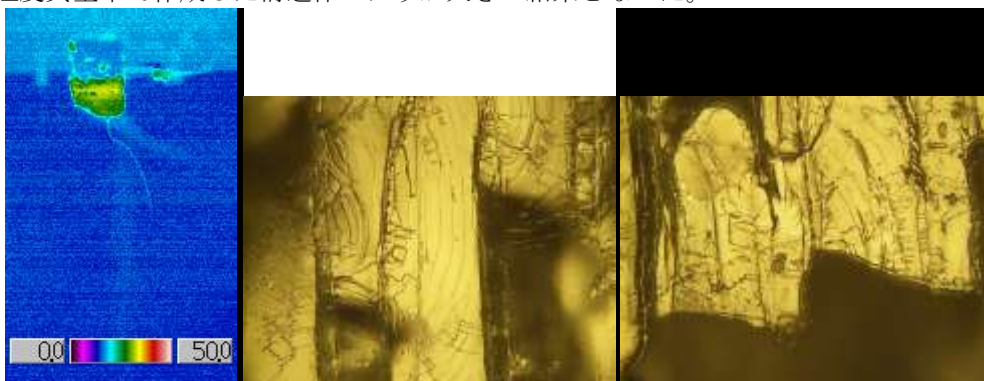
図3 射出環境における温度分布(左)及び真空中(中央)・大気中(右)の破面観察結果
