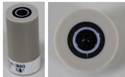
図 2. 酸化物触媒と導電助剤のアセチレンブラックをペースト化し、グラッシーカーボン回転リングディスク電極上に塗布した直後の状態。
