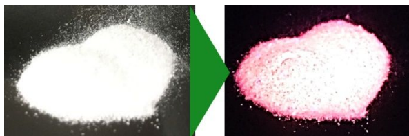
図 3 Eu(III)イオンドープ水酸アパタイト/クエン酸複合ナノ粒子へ UVA 光を照射した際の蛍光写真。(左) 光照射前、(右) 光照射時。
