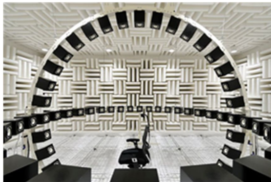
図1 実験に用いたスピーカアレイ(東北大学電気通信研究所)
