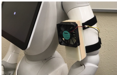
図4：人型ロボット腕部に設置した芳香提示装置
