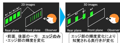
図2. Edge-based DFD表示の原理
