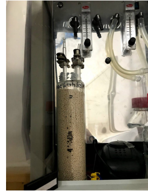
図 6 大気水蒸気捕集システムの概要
