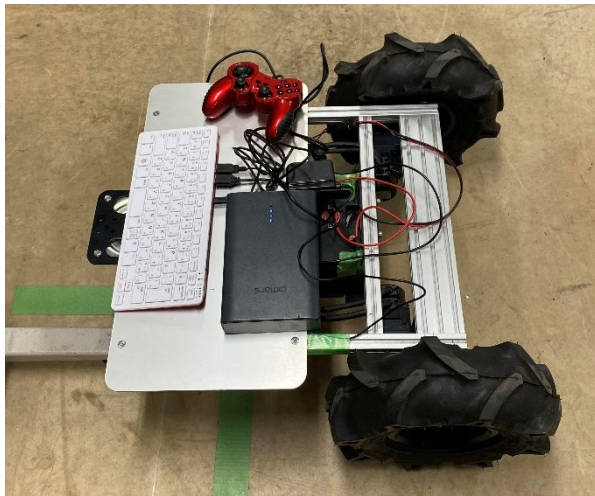
図 2 . 移動型ロボットシステム . キーボードは Raspberry Pi 400 でプログラム搭載可能 .
