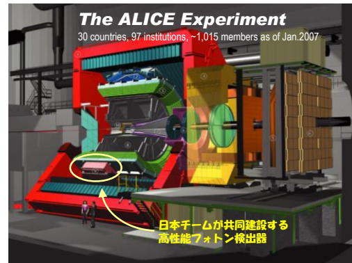
図 1 ALICE 実験装置と日本チームが共同建設した高性能フォトン検出器 PHOS.
