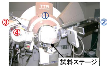
図1 実験室系 X線回折装置の X線源 (3) の直後に、多層膜集光ミラー (4) と非対称反射結晶を取り付け、ゴニオメーター (1) の試料ステージで X線の集光し、右側受光側のアームにスリット系を配置することで IP(2) の SN 比を格段に上げることができ、下図のように室温において放射光 X線での測定に匹敵するスペクトルを得ることに成功した。
