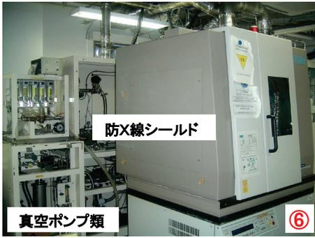
図6 本体の後ろに真空ポンプ類および排ガス処理系。X線発生装置の電源制御部は⑥である。
