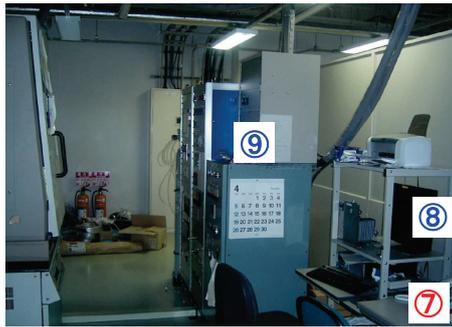
図7 X線ゴニオ制御部(⑦)、解析用PC(⑧)及び原料ガスの流量制御系(⑨)を本体の前面に備えている。
