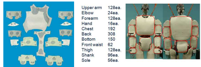
図1：触覚センサの実装
