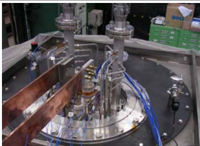
図5, 配線、配管も完了し、試運転中
