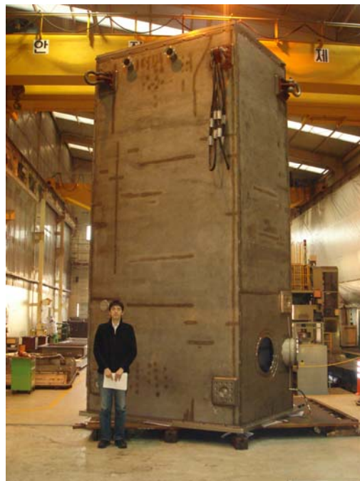
図7, 製作された大型真空槽の実機。これが J-PARC に設置された。
