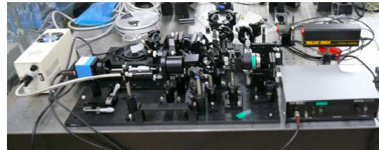
図13 フェムト秒ポンププローブ実験装置. 構成図(上)と写真(下).
