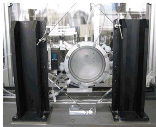
図6 試作したφ125 mm ノズルの外観
