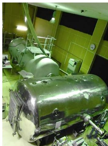
図1 火星大気風洞の全体構成
