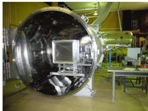
図2 真空チャンバ内の風洞本体
