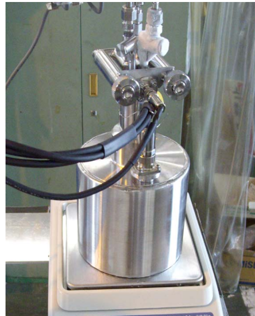
超軽量な宇宙機搭載型の強磁場発生装置 (5テスラ級)
