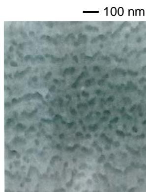
集合状態にあるポリマー溶液から作成したフィルムは、表面層のみならず断面全体に亘って約50ナノメートルの親疎水相分離構造を有していることがわかった。溶液中での逆ミセル形成能と相関して、ポリマーフィルム中の糖鎖ナノスポットの形状もまたポリマーの一次構造に依存していた（下図）。
