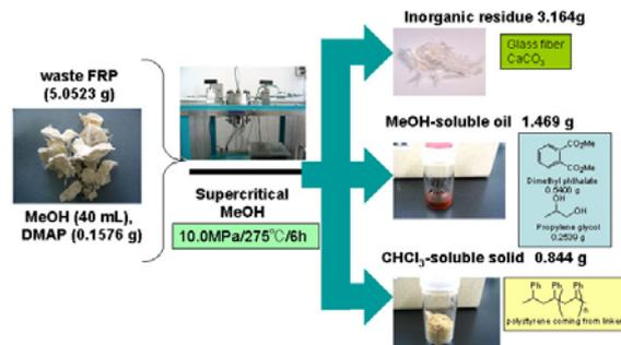
このように、それまで処理困難であった廃 FRP を解重合するだけでなく、それぞれの成分ごとに分離できることがわかった。この反応はメタノール中では加えた DMAP の量に依存して進行することがわかった。この実験に用いた樹脂の有機成分は約 50%であったので、有機成分を可溶化した場合は不溶性残渣の割合は 50%程度となり、可溶化や解重合の進行が悪いとその割合が増えてくると考えられる。そこで、不溶性残渣の重量%を算出し、解重合反応の進行具合を見積もった。
