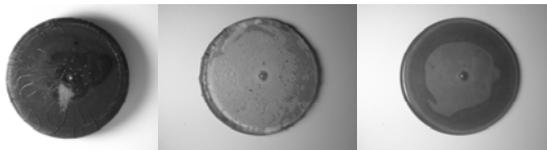
このようにして合成した再生プラスチック（左から回収フタル酸ジメチルが 100%, 40%, 0%）の硬度試験を行ったところ、回収フタル酸の量が増えるにつれて硬度は低下し、柔らかいプラスチックとなることがわかった。回収フタル酸ジメチルの量が 50%以下の場合では新品樹脂とそれほど遜色ない硬度の樹脂ができるが、それ以上に回収フタル酸ジメチルの量を増やすと急激に硬度の劣化がみられた。
