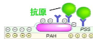
図6 抗PSA抗体を固定した金ナノロッド固定基板の模式図
