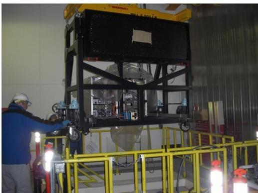
図1. ナスミス焦点用アダプタに分光器(黒い構造物上方の塊)を設置した後、ナスミス階クレーンを用いて、カセグレン階からナスミス階へとつりあげているところ。写真上部の黄色いつりあげ治具は国立天文台ハワイ観測所に設計・製作していただいた。他の装置の治具としても使用可能である。
