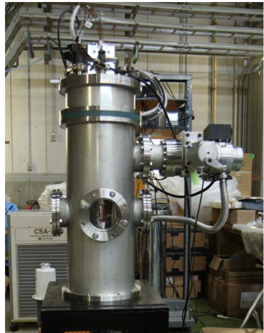
図8；ガス吹きつけ方式による薄肉窓なし固体水素標的クライオスタット。上部にGM方式の小型冷凍機があり、横方向にセットされているのは排気速度 150 1/s のターボ分子ポンプである。
