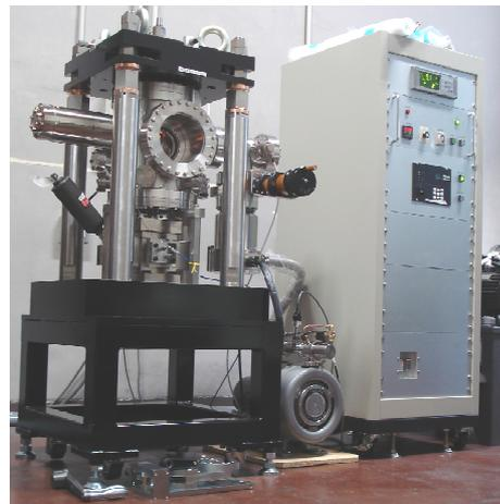
図 2 超高真空疲労試験機
