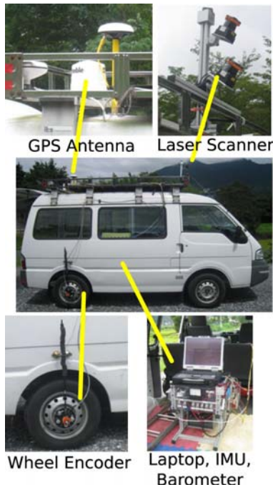
図 6 計測装置の車上配置
