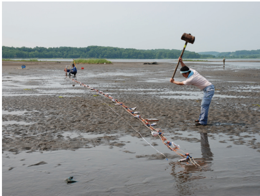
写真1 MASWの実施状況
