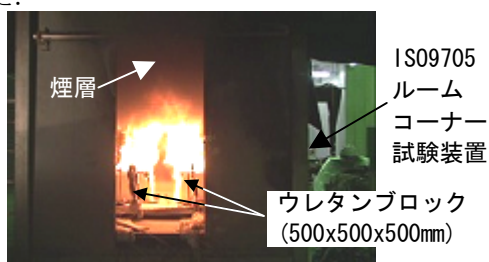
図11 室内でのウレタンブロックの燃焼状況
