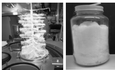
図5 アセチルアセトン亜鉛ファイバーの生成の様子と得られた試料
