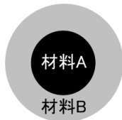
図1 新構造ワイヤ (ハイブリッドワイヤ) 材料A: 芯線、材料B: フープ
