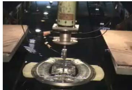
図6 拘束模型による流体力計測
