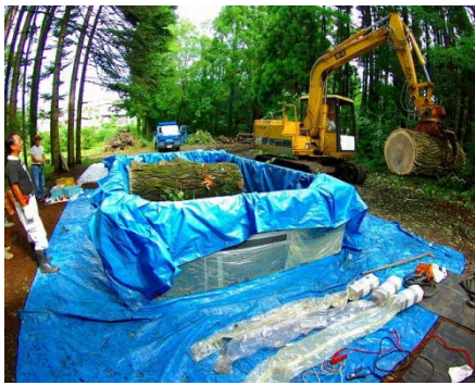
図-1 DBH 1 mの巨木の個体呼吸測定 この個体は数回に分けて測定した。枝、根、葉のすべてをチャンバーに入れて測定した。測定終了時に、切断直後の呼吸と比較して変化を調べたが、切断の影響は無かった。チャンバー作成に利用した資材はすべてCO 2 バリア性能を確認して、完成したチャンバーのリークテストも行った。手間に3つあるのがダクトのある空気攪拌ファン。
