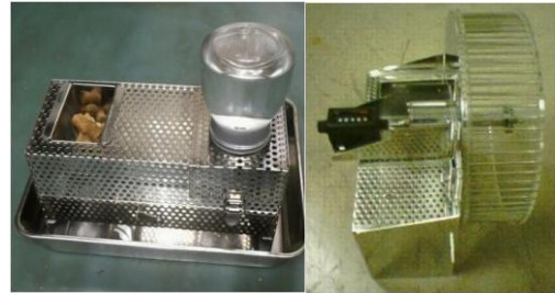
図 1. 金属製網床ケージ。左: 非運動群用ケージ。右: 運動群用回転車付きケージ。
