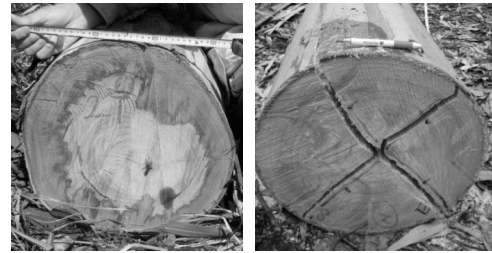
図4. 玉切りによって生じる Eucalyptus grandis 丸太横断面の心割れ。左は熱帯ブラジル (Acailandia)、右は亜熱帯ブラジル (Porto Alegre—南緯31度) の植林地でのもの。
