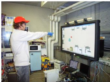
図2 ユーザーの注意方向の計測実験風景：ディスプレイ上の3つのカメラによってユーザーの動きをトラッキングする。
