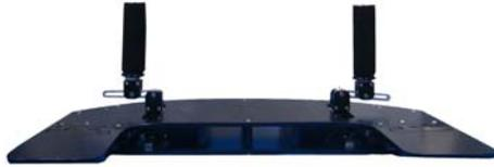
図3 レバー式操作装置
