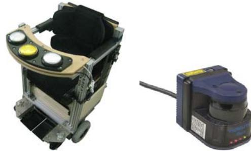
図5 円型車椅子外観 図6 障害物検知センサ
