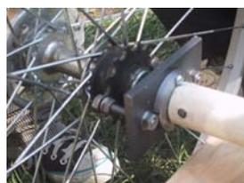
図8 W教室の解決案, タイヤを20mだけ回転させる。自転車の部品を流用し重力を利用する
