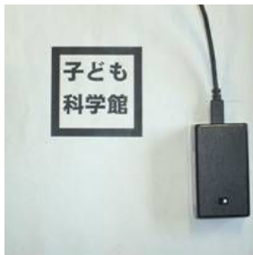
図5. 製作した脈拍検出器(右)とマーカー(左)
