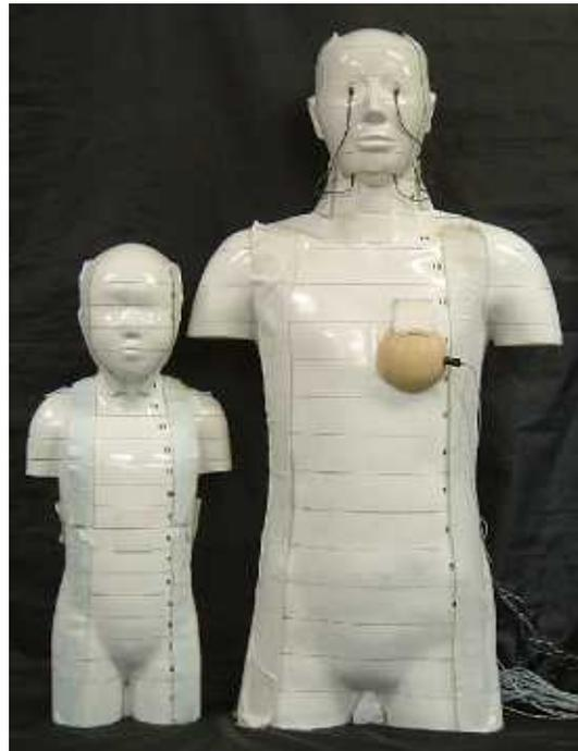
図 3.1 線量計を埋め込んだ成人用(右)および小児用(左)人体ファントム臓器線量計測体系
