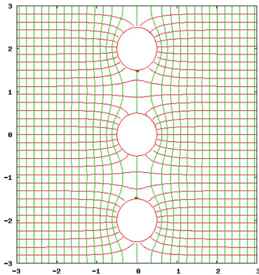
図(3-i)：周期的円柱導体列のある場に、導体列に垂直な方向に一様電場を与えたとき生じる電場。赤い線は電気力線、緑の線は等ポテンシャル線を表す。
