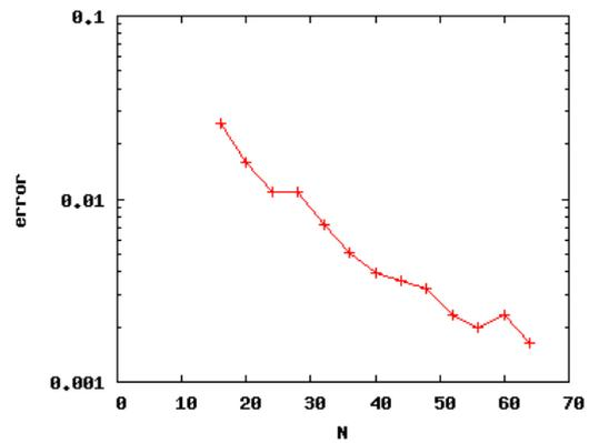
図(3-ii)：周期的に並ぶ円柱導体列のある場に一様電場をかけた場合（図(3-i)の例）の静電ポテンシャルを本研究の CVBEM で計算したときの、近似ポテンシャルの誤差。縦軸は相対平均誤差、横軸は節点数  $N$  を表す。
