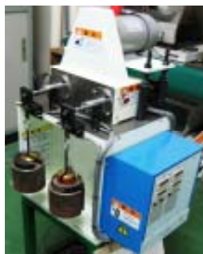
図 1-1. 4 連式回転曲げ疲労試験機
