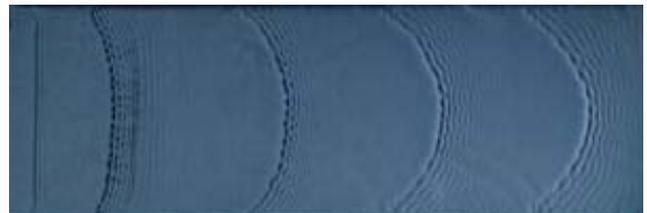
図 2 傾斜面を流下する Roll wave のシャドウグラフ像
