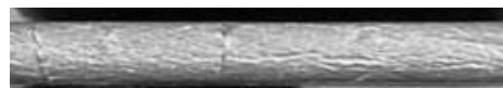
図11 6016に0.5%のFeを添加し、Fe量を0.8%した合金板の180度密着曲げ。1mmまで冷間圧延した後、530℃で1hの溶体化処理を施した。
