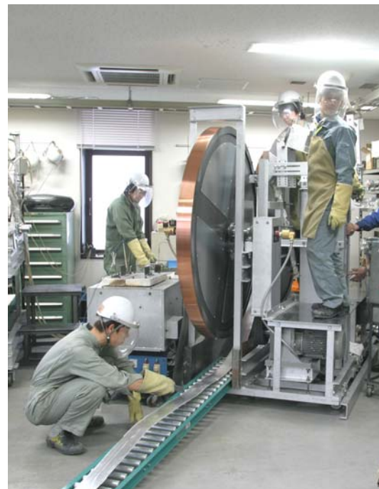
(c) 薄板の casting 風景 (60m/min)
