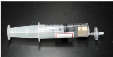
図1 シリンジを利用したアセトアルデヒドの測定法
