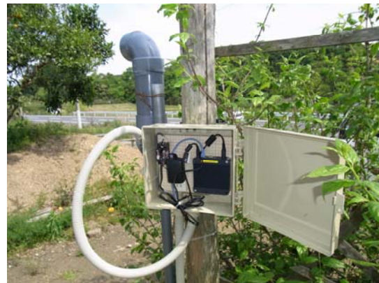
図3 USB Webcam の屋外設置
