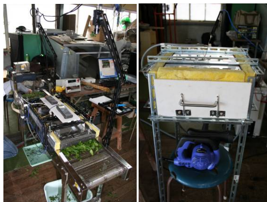
図1 試作したベルトコンベア型殺青機（左）と回分式殺青機（右）
