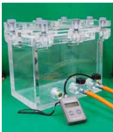
図1 実験用加圧チャンパー
