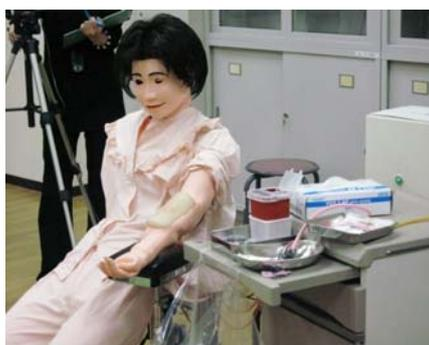
写真2. 生体模擬ロボット
