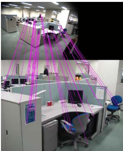
図1：環境カメラ画像情報を用いたモバイルカメラのキャリブレーション方式
