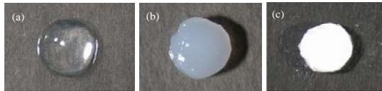
図2 ゲル内石灰化誘導と無機/有機複合体の作製
