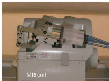
図 4 非金属空圧ステッピングアクチュエータによる 2 自由度ロボット 上) 原理図 下) MRI 内に導入した実験時の概観
