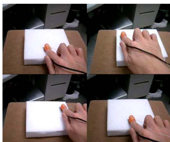
図 6. 弾性体操作時の位置・姿勢・力計測
